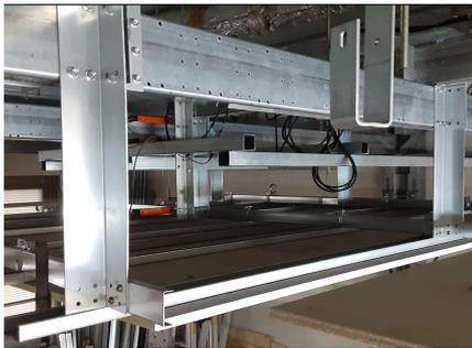
試験後 中央束材・野縁受け止付部
