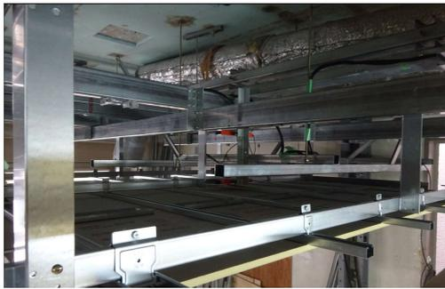
試験後 中央束材・野縁受け止付部
